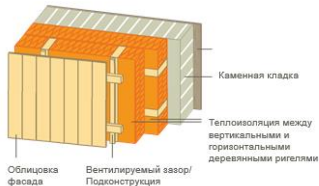
Рисунок 4 Структура вентиляруемого навесного фасада
